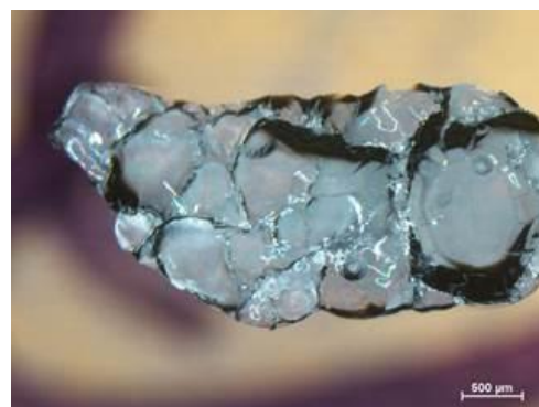
Photo d'un défaut de silice dans un verre plat
